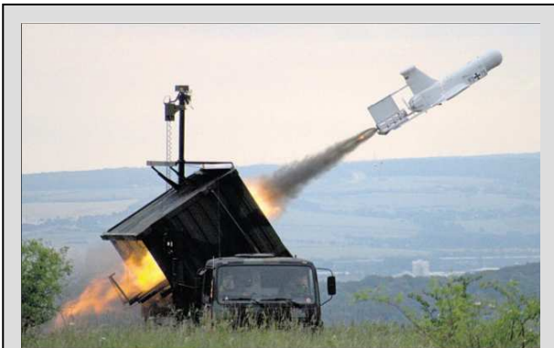
Feuriger Start per Raketenantrieb. Das Kleinfluggerät für Zielortung wird dann vom Propeller in der Luft gehalten. Es erreicht Fluggeschwindigkeiten von bis zu 210 Stundenkilometern. Bild: Artilleriebataillon 131/Max Horrmann
