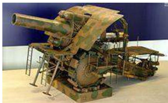
Modell der Dicken Bertha (*M-Gerät*) mit Schild und Wartungsgeländer. Die beiden Stützen am vorderen Ende der Lafette sollten ein Überkippen nach vorne verhindern.
